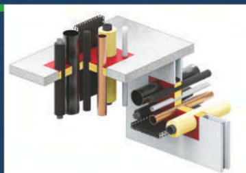
PROTECCION CORTAFUEGO PARA CABLES Y CAJAS ELECTRICAS
