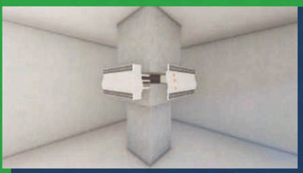
SELLADO CORTAFUEGO PARA AISLADORES SISMICOS
